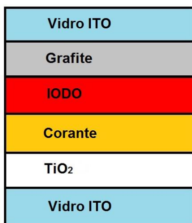
Figura 2 Esquema da célula de Grätzel mostrando as camadas, duas de vidro ITO, uma de TiO 2 , uma de corante, uma de grafite e uma de iodo.
