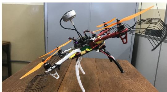
Figura 10 (b) – Dispositivo de proteção das hélices: Aeronave com proteção de hélices
