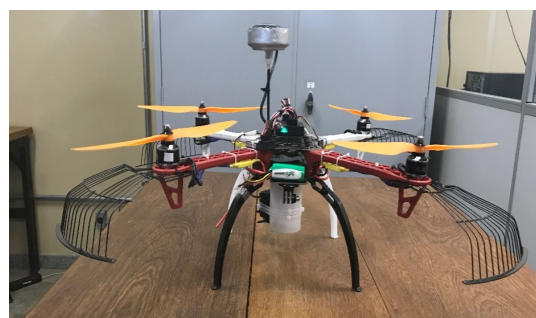
Figura 7 – Dispositivo de proteção das hélices acoplado ao drone.
