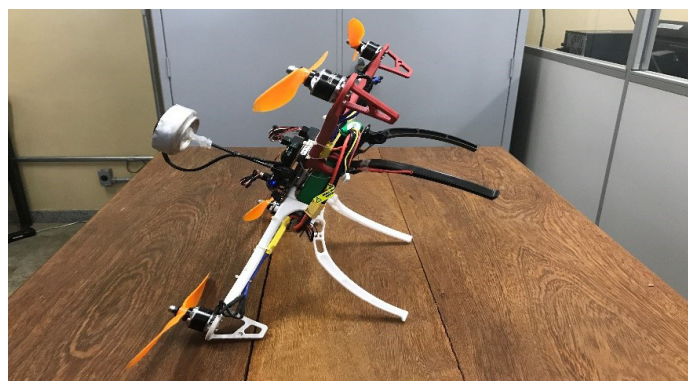
Figura 10 (a) – Dispositivo de proteção das hélices: Aeronave sem proteção das hélices
