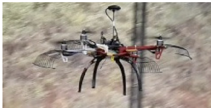
Figura 11 – Aeronave em voo utilizando o dispositivo de proteção das hélices.
