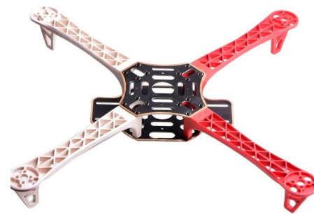
Figura 1 (b) - Estrutura física do drone: Estrutura montada.
