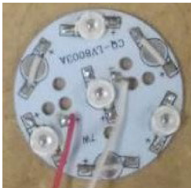
Figura 1 – Placa com LEDs infravermelhos de potência
