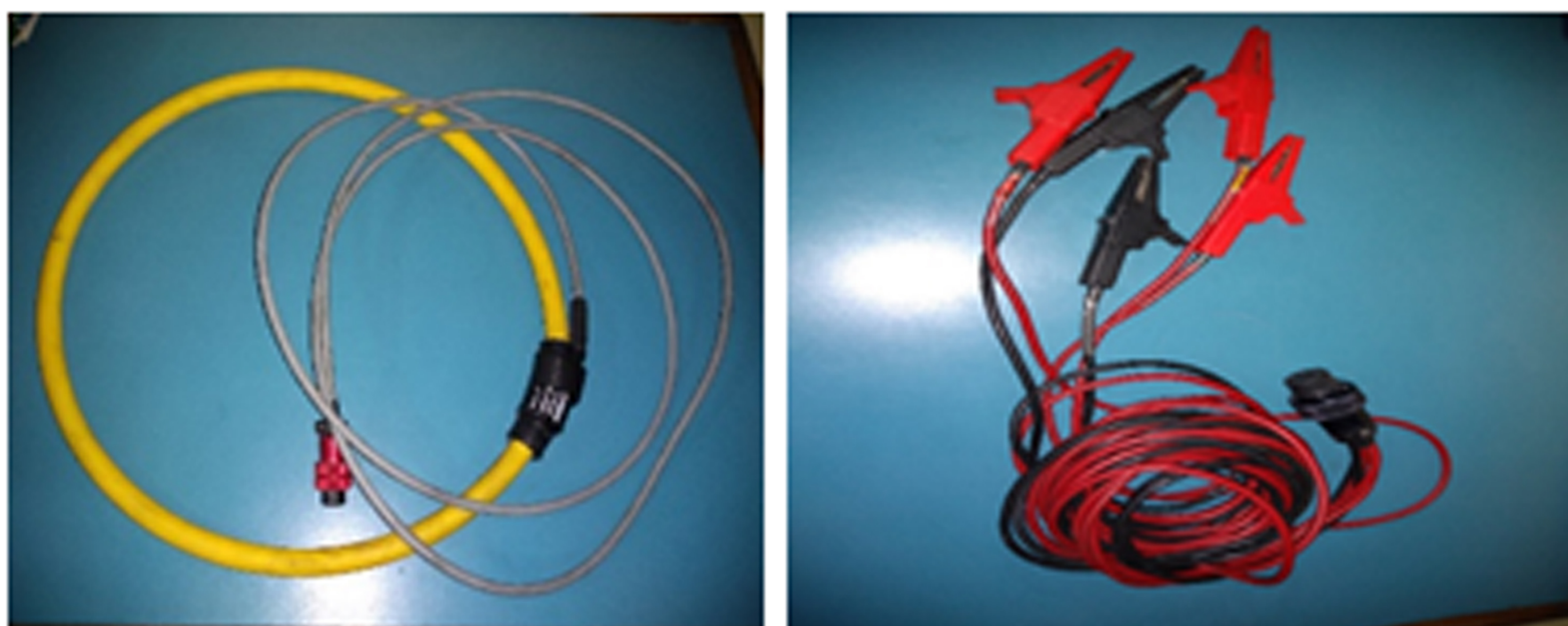
Figura 2. Foto de equipamentos utilizados: (a) bobina de Rogowski e (b) garra jacaré.
