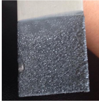
Figura 1: Eletrodo de alumínio com deposição de zinco.
