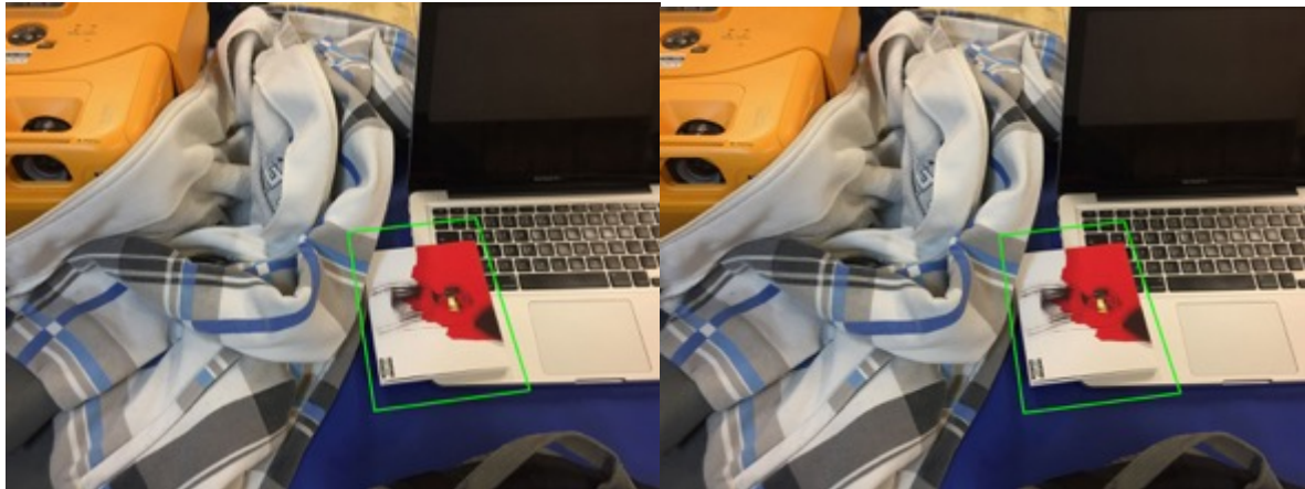
Figura 20. Objeto de estudo localizado usando o SIFT (esquerda) e objeto de estudo localizado usando o SURF
