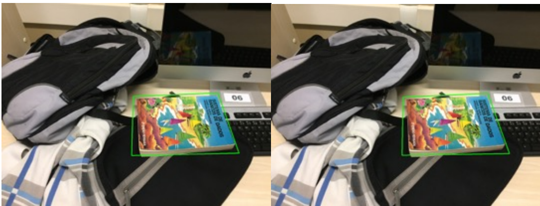
Figura 15. Objeto de estudo localizado na Imagem objeto usando o SIFT (esquerda) e Objeto de estudo localizado usando o SURF
