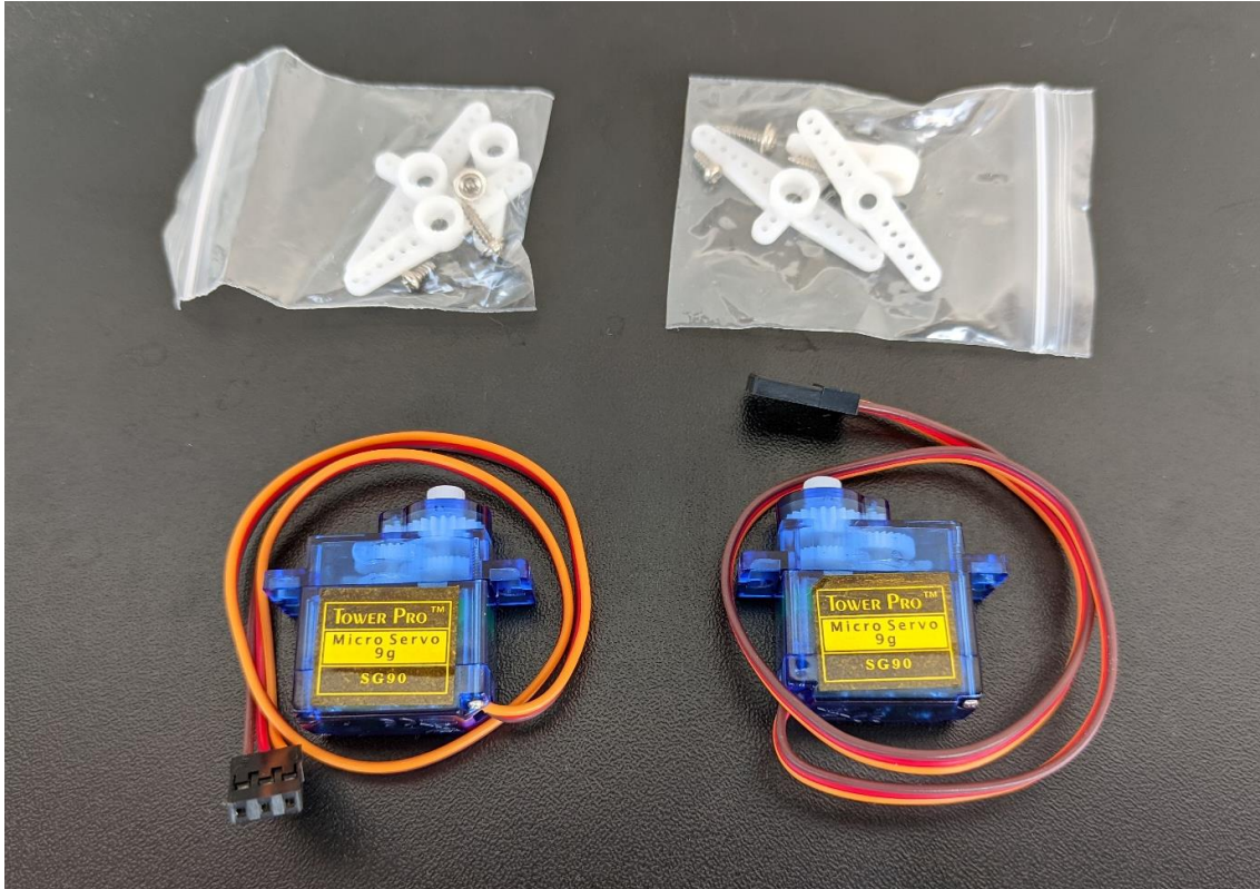
Figura 4 – Foto de dois Kits do Micro Servo Tower Pro SG90. Fonte: O autor.
