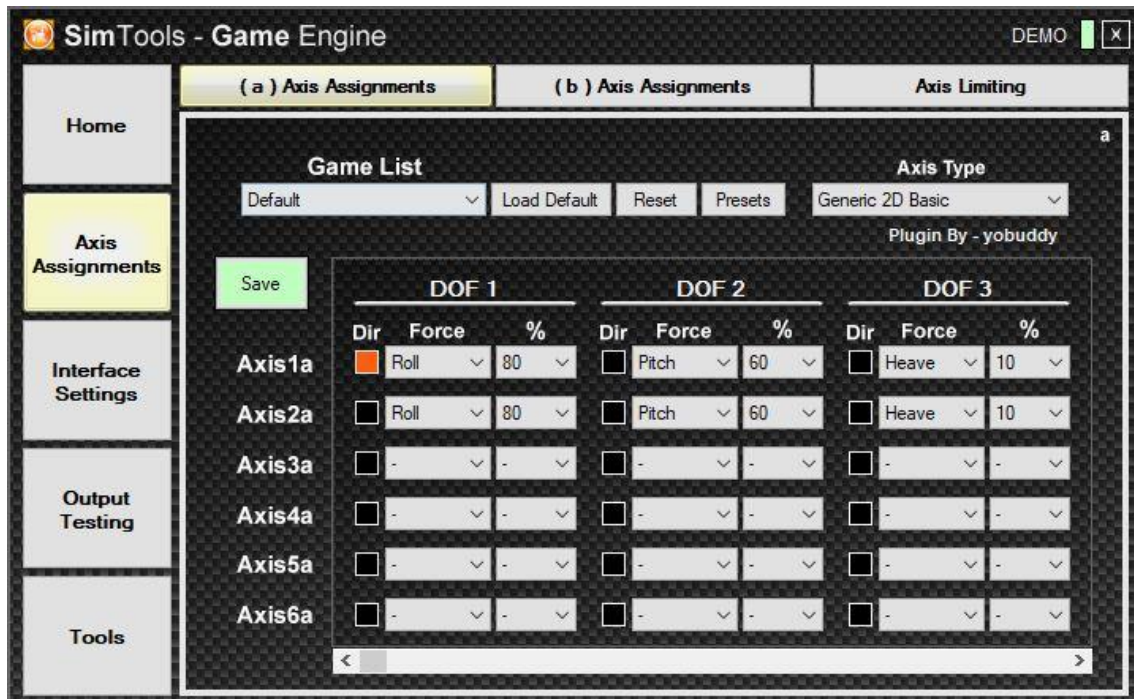
Figura 12 – Parametrização dos eixos de movimentação Roll, Pitch e Heave. Fonte: O autor.
