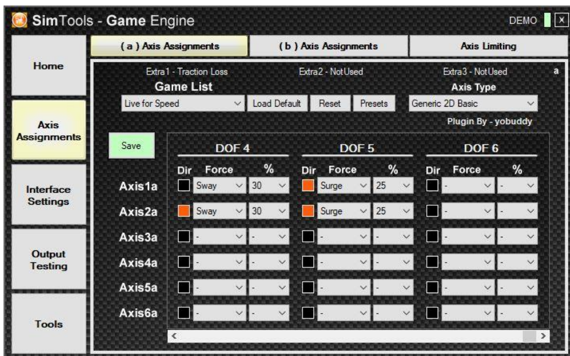
Figura 13 – Parametrização dos eixos de movimentação Sway e Surge. Fonte: O autor.
