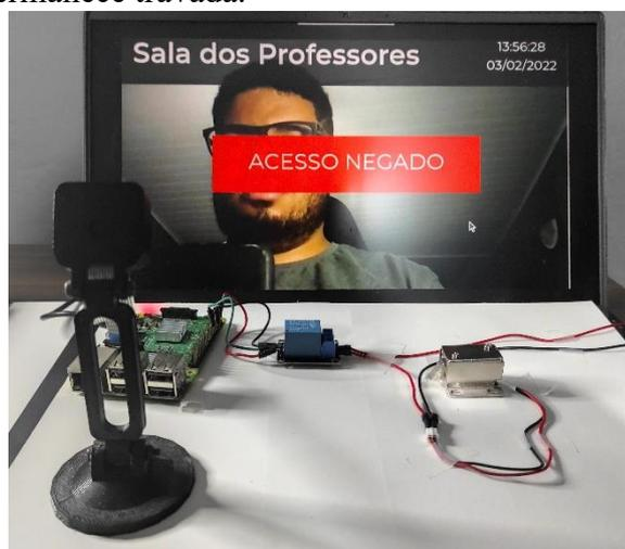
**Figura 19. Sistema em execução no protótipo negando o acesso**
