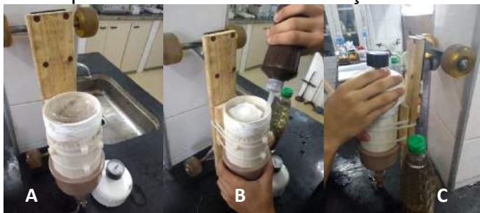
Figura 1. (A) Protótipo aberto mostrando o compartimento interno que separa os reagentes. (B) Adição do ácido acético. (C) Protótipo fechado e pronto para funcionamento.
